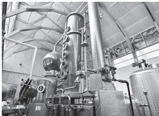
アーノルドホルスタイン社のハンドメイドのジン専用蒸留器。
