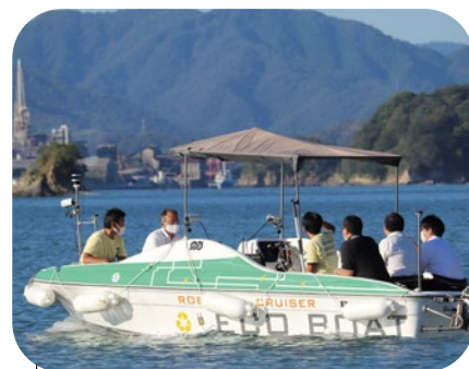
コンピュータ制御された自律航行船で日 用品を運ぶ実証実験（広島県野島）
