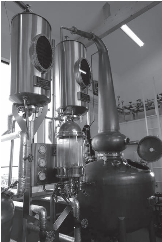
ウイスキー製造用のポットスチル（蒸溜器）。
